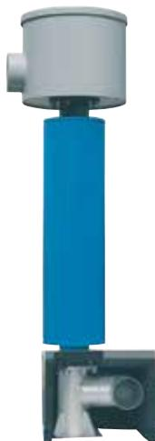
Kit spécial pour les Robox amenés à travailler sous vide, consistant en des silencieux d'absorption SDL et des silencieux d'échappement SPS. Il permet de réduire le niveau de bruit généré par l'échappement de 25 dB(A) environ, dans la plage de champ de fréquence de 200 Hz à 20 kHz.
