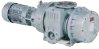
Berührungslos arbeitende Wälzkolbenpumpe mit Saugvermögen 485 bis 1.909 m<sup>3</sup>/h, vorzugsweise zum Abpumpen von Gasen und Dämpfen im Grob- und Feinvakuumbereich, da weitgehend unempfindlich gegen Wasserdampf und korrosive Dämpfe. Zum Erreichen des erforderlichen Vorpakums wird eine Vorpumpe benötigt. Die Flanschmotoren entsprechen DIN EN 60034, sind in Schutzart IP 55 und Isolationsklasse F ausgeführt.
