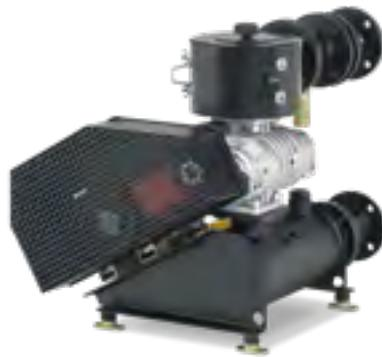
Das berührungslos arbeitende 2-flügelige (R-WVB 25) bzw. 3-flügelige (R-WVB 120 bis 8.300) Wälzkolbengebläse SHARK ist für den Vakuumbetrieb bis max. 0,5 bar (abs.) geeignet. Die 16 Baugrößen haben ein Saugvermögen von 22 bis 8.580 m<sup>3</sup>/h. Geräusch- und pulsationsarm, hoher Wirkungsgrad durch optimale Gebläse-drehzahlen, stabile Ausführung, service-freundlich.
