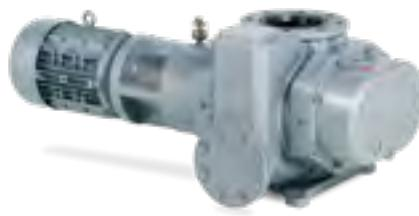
Berührungslos arbeitende Wälzkolbenpumpe mit Saugvermögen 2.293 bis 2.752 m<sup>3</sup>/h, vorzugsweise zum Abpumpen von Gasen und Dämpfen im Grob- und Feinvakumbereich, da weitgehend unempfindlich gegen Wasserdampf und korrosive Dämpfe. Zum Erreichen des erforderlichen Vorpakums wird eine Vorpumpe benötigt. Die Flanschmotoren entsprechen DIN EN 60034 Isolationsklasse F ausgeführt.
