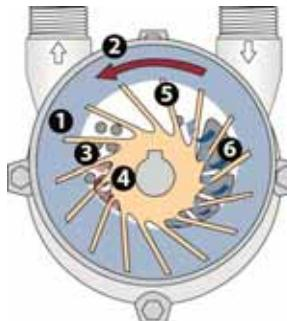
Bei Flüssigkeitsring-Vakuumpumpen/-Kompressoren der L-Serie rotiert das Laufrad (4) exzentrisch und berührungslos im Pumpengehäuse (2). Ein rotierender Flüssigkeitsring (1) dichtet die Laufradschaufeln untereinander und stirnseitig ab. Dieser Flüssigkeitsring wird durch die Rotation des Laufrades erzeugt und liegt am Pumpengehäuse an.
