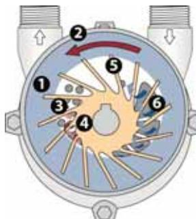
Sur les pompes à vide et compresseurs à anneau liquide de série L, la roue (4) tourne de manière excentrique et sans contact dans le carter de pompe (2). Un anneau liquide rotatif (1) assure l'étanchéité des pales entre elles et côté étoile. Cet anneau liquide est créé par la rotation de la roue et est plaqué sur le carter de pompe.
