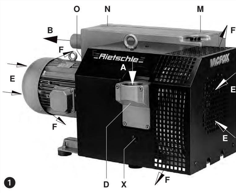
Una válvula antirretorno incorporada de modelo estándar dispuesta a la entrada de la bomba separa a ésta del proceso cuando se decide para la bomba. Evita la penetración del aceite en el cilindro de la bomba cuando ésta se halla parada. Un exceso de aceite en el cilindro podría originar un cierre hidráulico si la bomba se pone en marcha, ocasionando someter a esfuerzos indebidos a los álabes del rotor.
