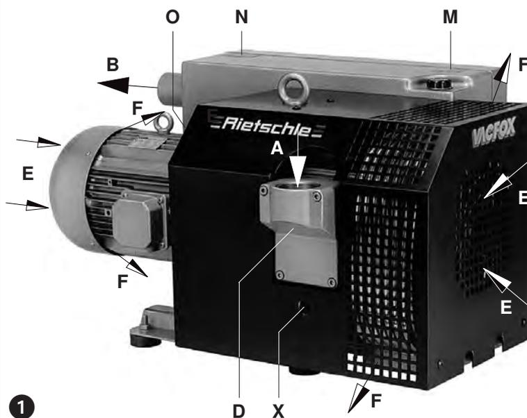
Un clapet anti-retour intégré évite après l'arrêt de la pompe, à la fois une entrée d'air dans le réservoir vidé, ainsi qu'une accumulation d'huile dans la chambre de compression; ce qui pourrait provoquer des à-coups d'huile lors du redémarrage.
