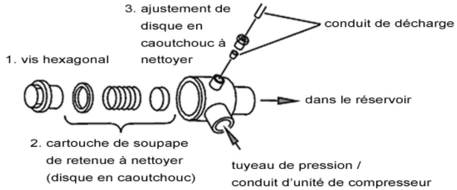
Si la membrane en caoutchouc de l'élément de la soupape de retenue est trop usée, il est nécessaire d'échanger l'élément tout entier.
