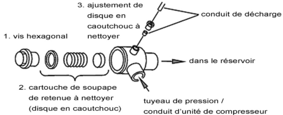
Si la membrane en caoutchouc de l'élément de la soupape de retenue est trop usée, il est nécessaire d'échanger l'élément tout entier. Si le siège de la membrane en caoutchouc dans la soupape de retenue ne peut plus être nettoyé, il est nécessaire d'échanger la soupape de retenue complète.
