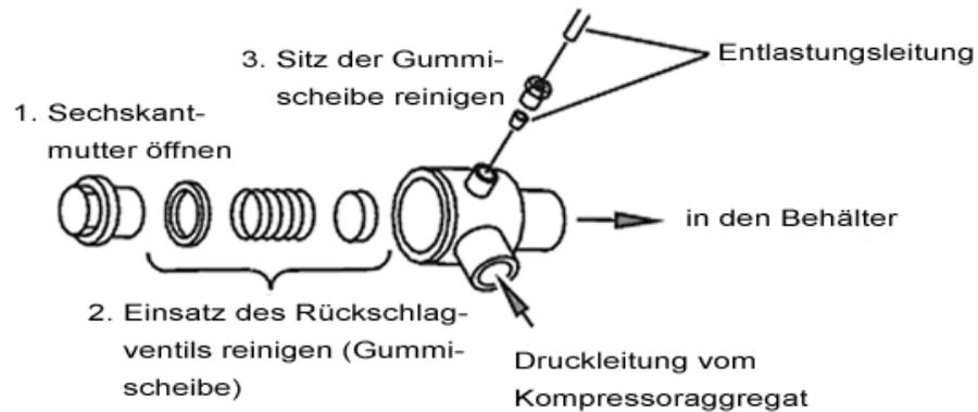
Ist der Rückschlagventileinsatz zu stark abgenutzt oder hart, muss der komplette Einsatz des Rückschlagventils ausgetauscht werden.
