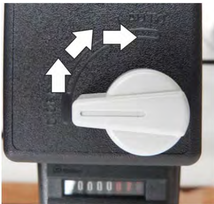
Fig. 31: Mise sous tension du compresseur
