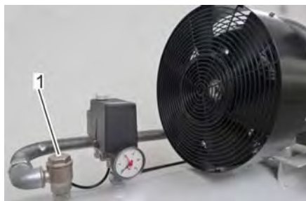
Fig. 8: Clapet à pression minimum et anti-retour
