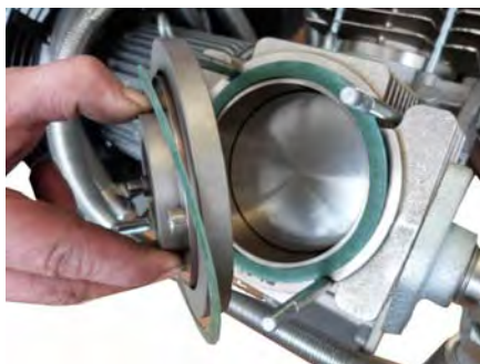
Abb. 44: Neue Ventilplatten aufsetzen
