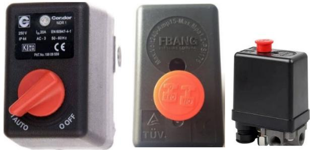
Der Ein-/Aus-Schalter gibt die Funktion des Druckschalters frei. Der Schalter schaltet den Kompressor in Abhängigkeit des erreichten Behälterdrucks ein oder aus. Der Kompressor arbeitet automatisch, hält bei Erreichen des maximalen Druckes an und startet dann wieder, wenn der Einschaltdruck erreicht wird.
