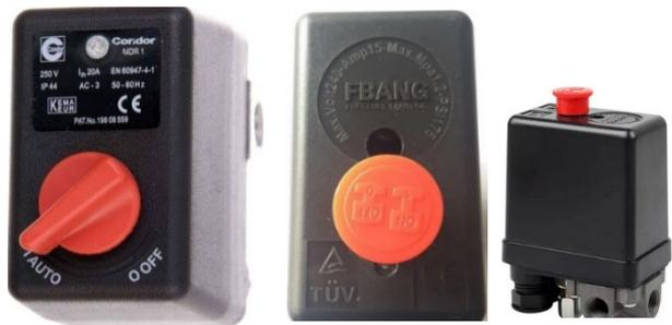
L'interrupteur marche/arrêt libère la fonction du pressostat. L'interrupteur met en marche ou arrête le compresseur en fonction de la pression atteinte dans le réservoir. Le compresseur fonctionne automatiquement, s'arrête lorsque la pression maximale est atteinte et redémarre lorsque la pression d'enclenchement est atteinte.
