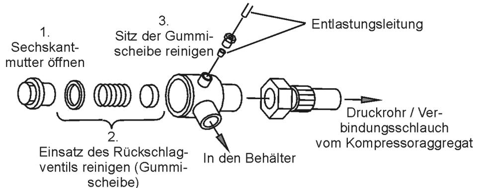
Ist der Rückschlagventileinsatz zu stark abgenutzt oder hart, muss der komplette Einsatz des Rückschlagventils ausgetauscht werden.
