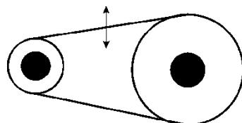
Bei einer Bewegungsfreiheit von 1,5 cm hat ihr Keilriemen die optimale Keilriemenspannung.
