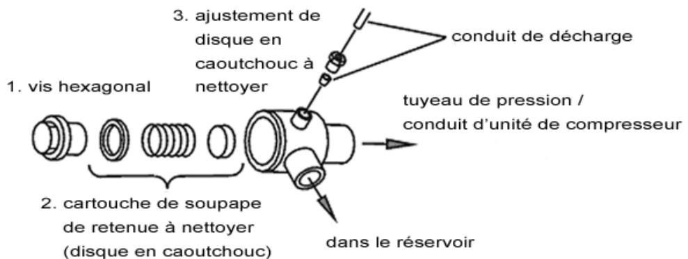
Si la membrane en caoutchouc de l'élément de la soupape de retenue est trop usée, il est nécessaire d'échanger l'élément tout entier.
