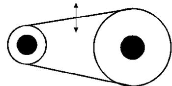
**Ajustage de la tension de la courroie trapézoïdale:**
