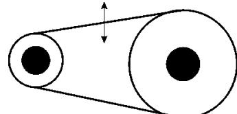
Bei einer Bewegungsfreiheit von 1,5 cm hat ihr Keilriemen die optimale Keilriemenspannung.
