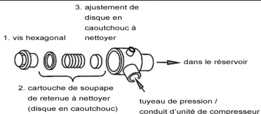
Si la membrane en caoutchouc de l'élément de la soupape de retenue est trop usée, il est nécessaire d'échanger l'élément tout entier.
