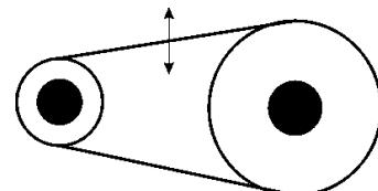
**Contrôle de la tension de la courroie trapézoïdale:**
