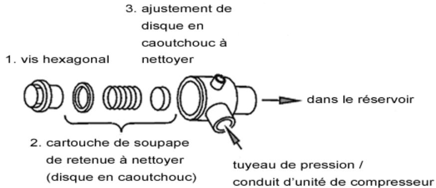
Si la membrane en caoutchouc de l'élément de la soupape de retenue est trop usée, il est nécessaire d'échanger l'élément tout entier. Si le siège de la membrane en caoutchouc dans la soupape de retenue ne peut plus être nettoyé, il est nécessaire d'échanger la soupape de retenue complète.
