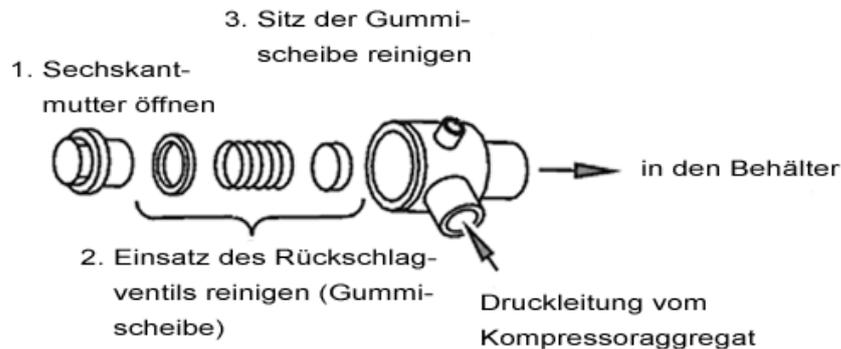
Ist der Rückschlagventileinsatz zu stark abgenutzt oder hart, muss der komplette Einsatz des Rückschlagventils ausgetauscht werden.
