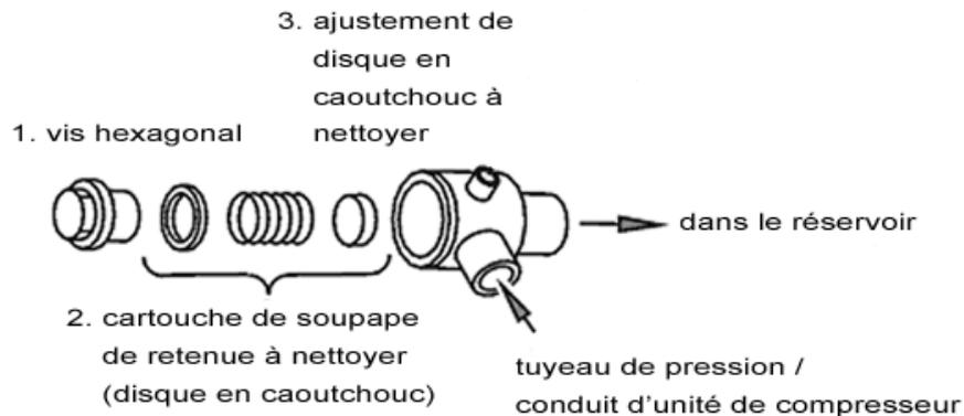
Si la membrane en caoutchouc de l'élément de la soupape de retenue est trop usée, il est nécessaire d'échanger l'élément tout entier.
