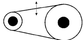
Bei einer Bewegungsfreiheit von 1,5 cm hat ihr Keilriemen die optimale Keilriemenspannung.
